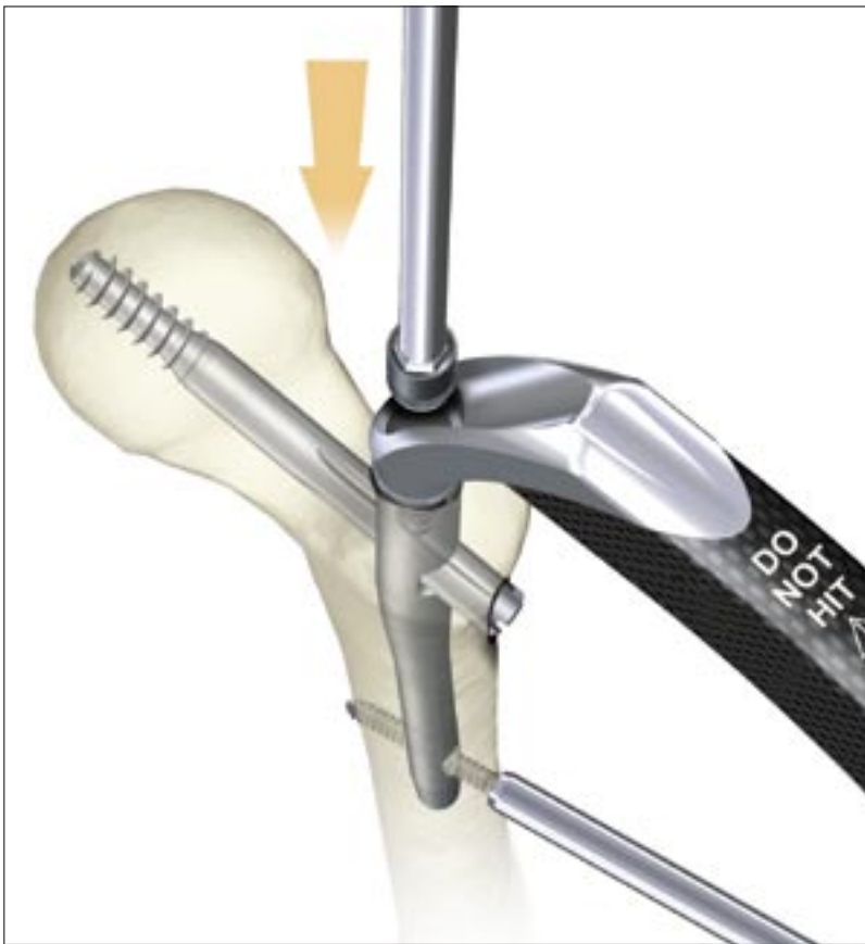
Figure 62 Mise en place du bouchon
